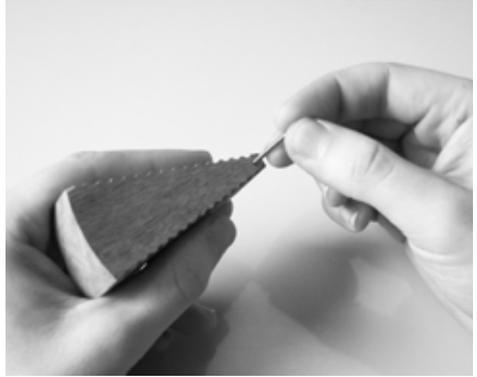
Nehmen Sie nun den Holzkeil und den Stahlstift zu Hand. Führen Sie den Stahlstift soweit durch die Bohrung in der Holzkeilspitze, dass er gleichmäßig an jeder Seite ca. 2 mm hervorsteht.
