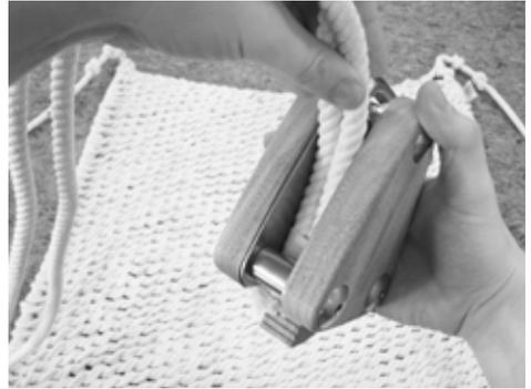
Nehmen Sie nun die Höhenverstellung so in Ihre rechte Hand, dass der Holzkeil knapp zur Hälfte in der Höhenverstellung steckt. Führen Sie das Ende des Seilpaares so auf die linke Edelstahl-Buchse der Höhenverstellung, dass die beiden Seile nebeneinander auf der Edelstahl-Buchse aufliegen.
