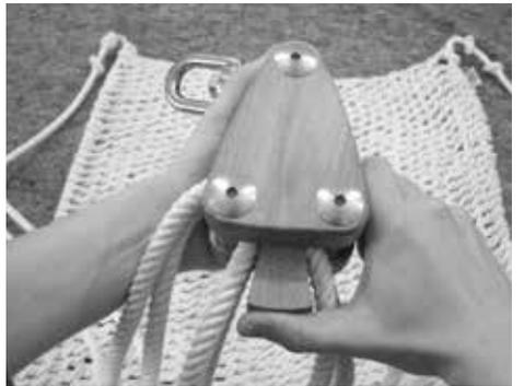
Nehmen Sie nun den rechten Verbindungsknoten in Ihre rechte Hand und verfahren Sie an dieser Seite genauso wie an der linken Seite. Wenn Sie auch das rechte Seilpaar durch die Höhenverstellung geführt haben, drücken Sie den Holzkeil in die Höhenverstellung hinein. Dies fixiert die Seile in der Höhenverstellung.
