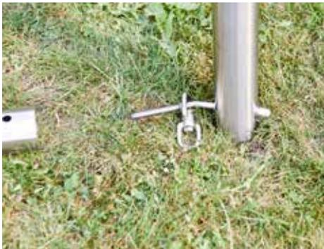
Setzen Sie nun die gebogene Gewindestange am oberen Ende ein und schieben Sie den Drehwirbel darüber. Schrauben Sie die Stange vorerst nur mit der Hand fest.
