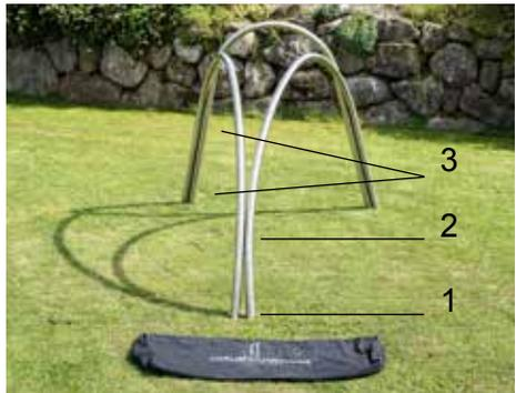
Fädeln Sie den zweiten Bogen in die gebogene Gewindestange ein und verschrauben Sie ihn. Alle weiteren M8 Gewindestangen verschrauben Sie am einfachsten in nummerierter Reihenfolge.
